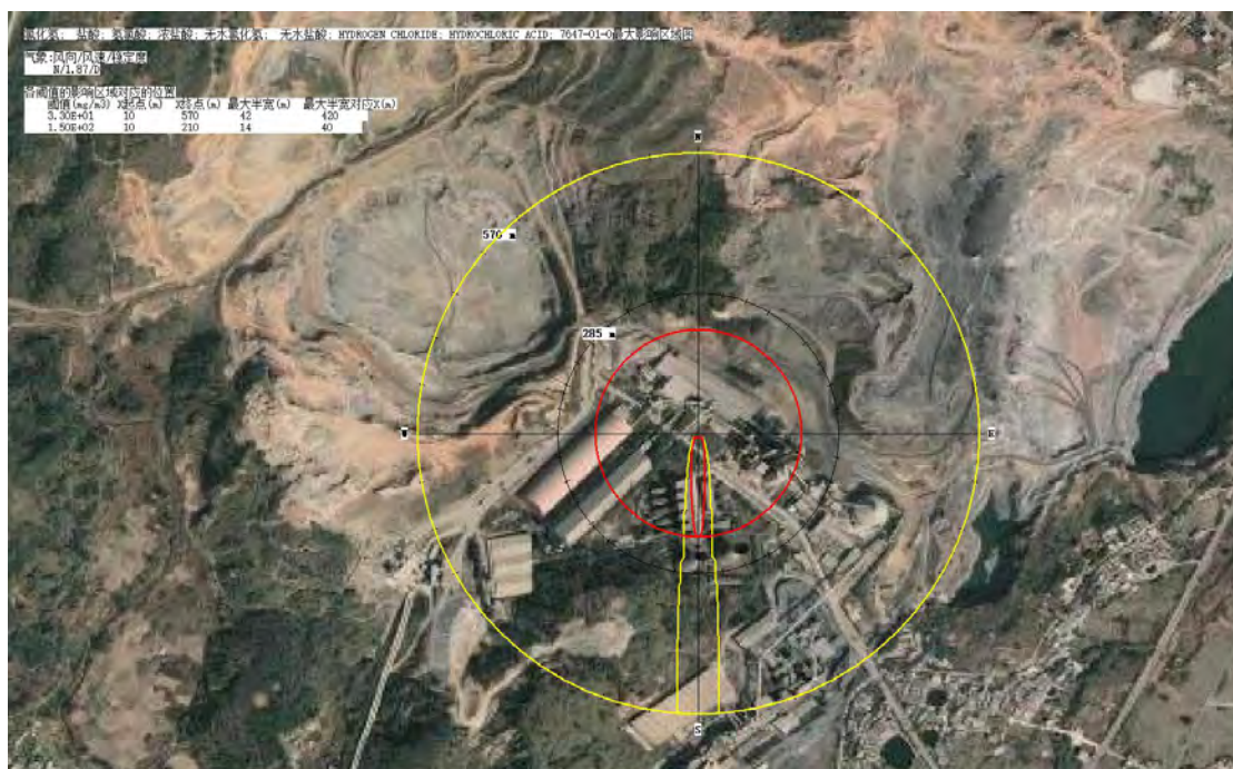
图 6.2.8.6-2 最常见气象 HCl 最大影响区域图 各关心点 HCl 浓度随时间变化情况见下表。
